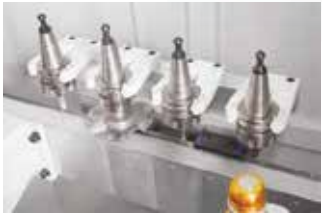
Servo Takım Haznesi 4 Takım Kapasiteli Takım Haznesi
