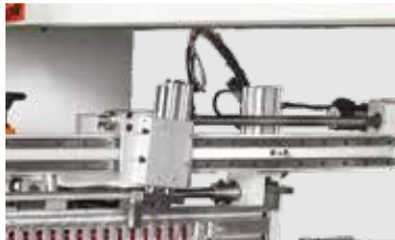
Servo Kontrollü Hassas Vidalı Mil
