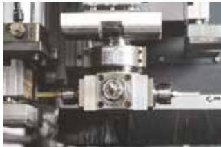
Döner Yan Frezeleme Aynı anda 4 takımı çalıştırabilir
